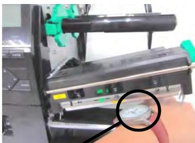
Achtung: Das Glas oder Metall einer Uhr kann den Druckkopf beschädigen.
