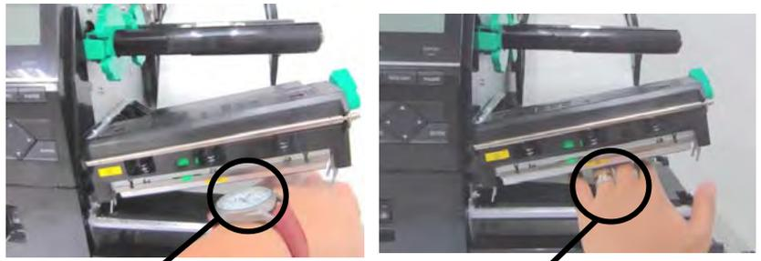
Achtung: Das Glas oder Metall einer Armbanduhr kann die Druckkopfkante beschädigen.
