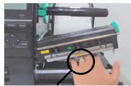
Achtung: Das Metall eines Ringes kann den Druckkopf beschädigen.
