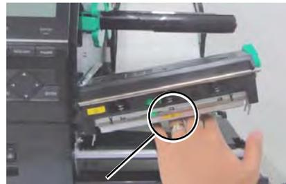
Achtung: Das Metall eines Ringes kann die Druckkopfkante beschädigen.
